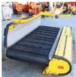
**ROC RT 380**, für Front- und Heckanbau, 6-Zinkenreihen, Geräteentlastung, Tandem-Tastrollen, Gewicht 900 kg
