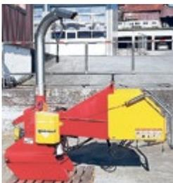
**Rabaud Natura 150 T Holzhäcksler**, Jg. 2007, Ast-Ø 150 mm, Dreipunktanbau, Zapfwellenantrieb
