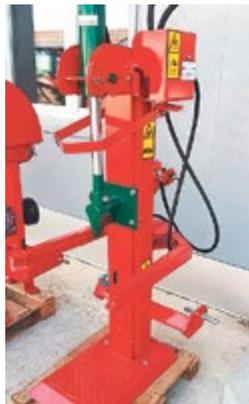
**Gyrax Formule Directe Ausstellungs-Holzspalter 13t**, Jg. 2015, Spaltlänge 1050mm, Messer 160mm, Steuerventil 2 Gänge
