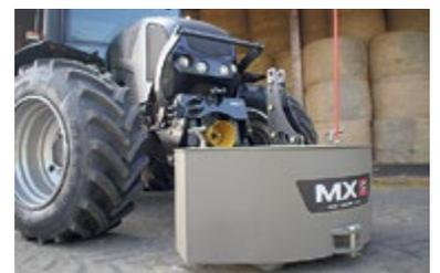
Das neue Gewicht von MX ist mit Hubvorrichtungen der Kategorien 2, 3 und 4 kompatibel. Der grosse vertikale Einstellbereich mit exklusiver MX-Verriegelung sowie dem Seiten- und Tiefenführungssystem für die Hubarme erleichtern das Ankuppeln enorm.
