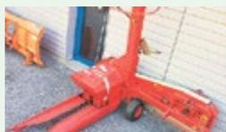
**PZ-Vicon MH 90 S Maishäcksler**, Jg. 1998, 1-reihig, Stützrad, Anhängervorrichtung mit Steckkupplung, Turmdrehung und Klappe verstellbar mit Bowdenzug, s. guter Zust.
