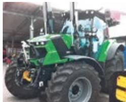
**Deutz-Fahr 6165.4 TTV Demo**, Jg. 2019, 165 PS, Getr. stufenlos, FZW, FH, DL-Bremse, FL-Konsole, 120l Load-Sensing Pumpe (Zeit + Menge einstellbar), Vorderachsfederung
