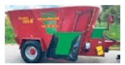
**Strautmann Verti Mix 1300 Double K, Futtermischwagen 13 m<sup>3</sup>**, 2 vertikale Mischschnecken, Austragsschieber vo. re. + li., geflanschte Zugöse Ø 40 mm, mech. Gegenschneiden, 11 Schneidmesser, rev.
