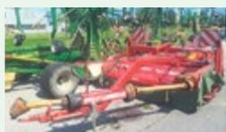
**JF GMS-2800 Mähwerk**, Jg. 1996, WW-GW, gezogen mit Deichselanhangung, hydr. Schwenkdeichsel nach re., guter Zust.
