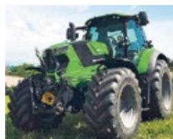
**Deutz-Fahr Agrottron 6215 TTV**, Jg. 2018, 1060 Std., Getr. stufenlos, 4 Heck- u. 4 Front-Steuergereäte, FZW, FH, DL-Bremse, ISOBUS, Piton Fix, K80, autom. AHK
