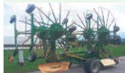
**Krone Swadro 1250 4-fach-Kreiselchwader**, Jg. 2001, Mittelablage, vorne 2 Kreisel 3.6 m und hinten 2 Kreisel 3 m, je 13 Zinkenarme à 4 Zinken, Arbeitsbreite hydr. verstellbar 11–12.5 m
