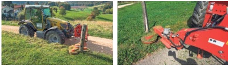
Mit dem Zaunkönig lassen sich Zaunpfähle äusserst einfach und effizient freimähen. Ohne beim Mähvorgang anzuhalten, mäht er sauber um den Pfahl herum und beseitigt auch unerwünschten Bewuchs unter stromführenden Zäunen. Beim Anfahren des Zaunpfahls knickt der Mähkopf zuerst ein, anschliessend dreht sich der Mähstern um den Pfahl herum. Die Metallklingen sorgen dafür, dass auch starker Bewuchs entfernt wird und der Nylon-Mähfaden garantiert ein sauberes Mäh-Ergebnis vor und hinter dem Pfahl.
