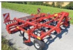
**Ökogrubber GSÖ-3**, Arbeitsbreite 3.0 m, mit Nachläufer RPV480
