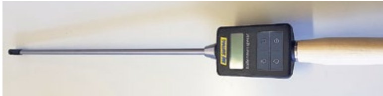
Oben: Ballenmessgerät für Feuchtigkeit und Temperatur
