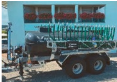
Farmtech Polycis 1100T, 11m 3 , 12m Schleppschuhwert. Schneckenpumpe, Saugarm, Load Sensing etc.
