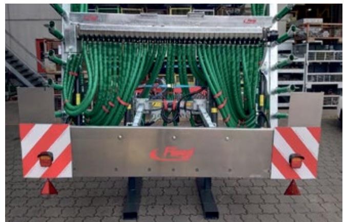
Schleppschuhdüsenschutz mit Beleuchtung und Warntafeln für Strassentransport, optional erhältlich
