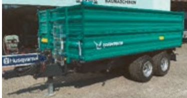
Farmtech TDK 1500, 15t, 13m 3 , Druckluftbremsanlage Tiefgänger, Kornschieber, konische Brücke
