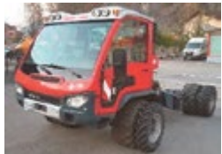
AEBI TP420 Jg. 14 1365 Std. Radstand 3.15m, DR v+h, Vorderachsfederung
