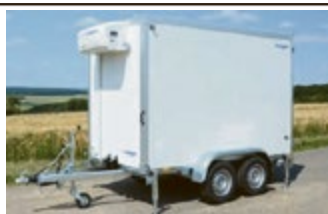
Fr. 7190.- GG 2700kg Isoboden 60mm Isowände 60mm, 4 Stützen 295 x 154 x 200cm, inkl. Kühlgerät
