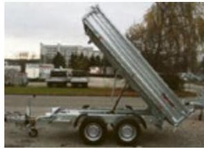
Fr. 5990.- GG 3,5 to Stahlboden, Stahlwände, 3-Seitenkipper Elektropumpe, 310 x 176 x 40cm
