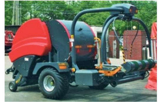
mit 2 × 500 mm Folienvorstrecker. Durch den, vom Winkelsensor gesteuerten Wickelvorgang, wird der Arbeitsablauf extrem schnell.
