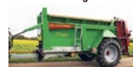
**Strautmann TS 140 Muldenstreuer,** Vol. 12.5m³, 14t Ges.gew., Bremsachsen BPW mit Druckluft, Bereifung 650/65 R 38, 2 stehende Fräsrollen
