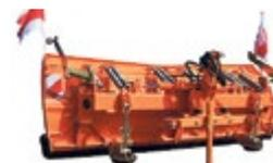
**Hydrac LB-II 260 DP neu,** Jg. 2018, Pflugschar mit Ausweichparabolisch, 3-Punkt-Anbau an FH, Gleitteller, Stahlschürfleiste, Querpeneleinrichtung
