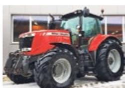
**Massey Ferguson 7620 Dyna-VT**, Jg. 2012, 3850 Std., 200 PS, FH, DL-Bremse, stufenloses Getriebe, Vorderachsfederung, hydr. Kabinenfederung, 2 Hydr.anschlüsse
