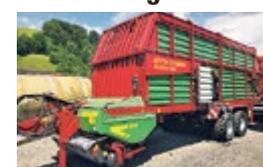
**Strautmann Ambion 360,** der Heuladewagen mit Schwingen, 35m³ nach DIN, 6 Messer, Heuaufbau geschlossen, Tandemachse, 520/50-17, Bremse DL mit ALB, ab MFK
