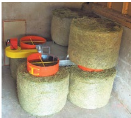
Ballenbelüftungsmodul für 8 Ballen
