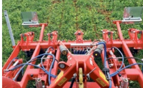
Einspritzanlage komplett aus Chromstahl inklusive Filtersystem
