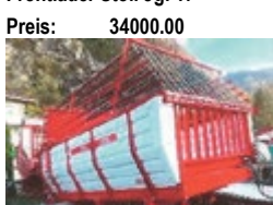
AEBI LD32LX, Ausführung lang, 21 m3 Hydr. Hecktor, 13 Messer Preis: 30000.00
