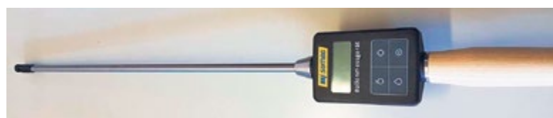
Ballenmessgerät für Feuchtigkeit und Temperatur
