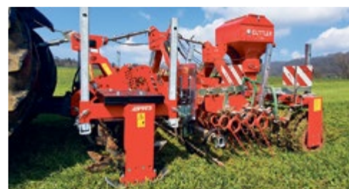
Grasnarbenbelüfter kombiniert mit GreenMaster zur intensiven Grünlandpflege und Mäusebekämpfung
