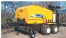
**New Holland BR6090 Kombipresse**, Jg. 2011, 8700 Ballen, 15 Messer, Rundballen 125 x 120 cm, Tandem-Achsen, 40 km/h, 1-Leiter-Hydraulikbremsen
