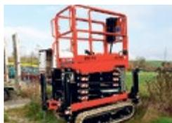
**BiBi 850-HE Raupenbühne**, Jg. 2017, 200 Std., Benz. Motor iGX390 und 230V E. Motor, Arbeitshöhe 8 m, Tragkraft 250 kg
