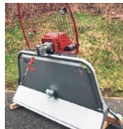
**Schlang & Reichart DW 861**, machine d'expo, année 2020, traction 8.6 t, freins proportionnels commandé par HBC radio, sortie de câble avec freinage intégré, système radio FSE 511 avec canal Patrol L
