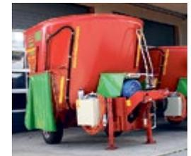
**Strautmann Verti-Mix 1801 Double, Demomaschine**, Austrag beidseitig, Maschinenhöhe 2.55 cm, Rezeptwaage, Getriebe 2-Gang
