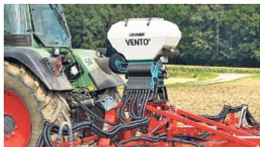
die preiswerte und leistungsstarke Alternative zum Hydraulikantrieb. Der VENTO® wird wahlweise mit einem 120, 230 oder 500l Behälter, serienmässigem Bedienteil und 8 bzw. 16 Abgängen geliefert.
