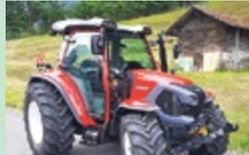
Lindner Lintrac 90 Demo, Jg. 2020, 102 PS, FZW, FH, DL-Bremse, 4 DW, stufenl. Getriebe, Allradlenkung, Joystick Umschaltung, hydr. Anhängerbremse 1-Leiter
