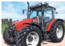
**Massey Ferguson 4245 4WD**, Jg. 2000, 85 PS, 2 DW, FZW, FH, Lastschaltgetriebe 40 km/h, Zugmaul halbautom., Oberlenker + Fangkugeln Kat. II, hydr. Anhängerbremse, 28 t Anhängelast, ab MFK, **FL Quicke Alö** inkl. Multikuppler
