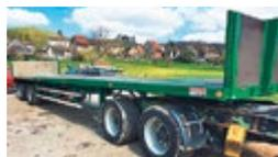
**Meusburger Sattelauflieger**, GG 30t, NL 26t, 2-Achs Auflieger für Dolly mit zwangsgelenkter 2er Achse, LxB 12.2x2.55m, sehr guter Zustand, total revidiert, ab MFK 40 km/h
