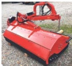
**Tehnos MB200LW Profi** Seitenmulcher, neu, Jg. 2019, 894 kg, Arb.br. 2 m, Seitenverschiebung 1.5 m, Walterscheid GW, Neigung bis 90° n. oben + 60° n. unten, 2 Reihen Gegenmesser für optimale Mulch-Wirkung
