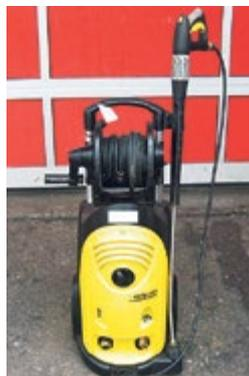
**Kärcher HD 9/19 Kaltwasser-Hochdruckreiniger**, Jg. 2005, Schlauchtrommel, Lanze mit Drehregler, Dreifachdüse + Rotordüse (Dreckfräser)
