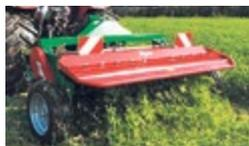
**Agrar Intensivauflbereiter IC 16 – IC 18 – IC 20**, Jg. 2020. Trennung von «Mähen vorne» und «Aufbereiten hinten» ermöglicht leichteres Trägerfahrzeug. Lockere und breitere Futterablage verkürzt Trocknungsdauer
