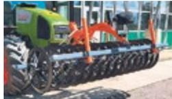
**Mandam MWC 3.0/700 Packerwalze**, Jg. 2020, Frontpacker, Arb.br. 3 m, 15 Ringe Ø 700 mm mit Reinigungsketten
