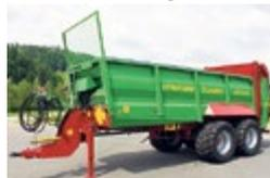
**Strautmann Kompoststreuer MS 1401**, Vol. 12 m<sup>3</sup>, Bereifung 650/40-22.5, 2-Teller Streuwerk, Komfortbedienung, Überladehöhe ab 233 cm, ab MFK 40 km/h
