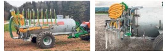
Ein weiterer Vorteil ist unser **eigener Hochdorfer-Verteilerkopf mit Excenter-CUT**. Dank den zwei selbstnachstellenden Schneidringen ist er ausgesprochen verstopfungsarm zudem weist auch einen geringen Verschleiss auf.
