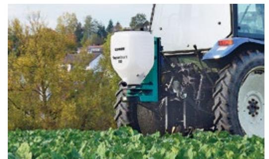
Ein 12 Volt Schneckenkorn-Streuer mit stufenlos einstellbarer Arbeitsbreite von 3 bis maximal 30m und der besten Querverteilung für Schneckenkorn von Einzelscheibenstreuern beim Test des Prüfinstituts IRSTEA. Weitere Details hierzu unter: [www.lehner.eu](http://www.lehner.eu)
