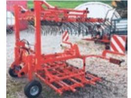
**HE-VA Hackstriegel 6m neu**, Jg. 2020, hydr. Klappung, Doppelzinken, 2 Räder höhenverstellbar, 5 versch. Zinken-Aggressivitäten, LED-Beleuchtung
