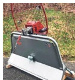
**Schlang & Reichart DW 861**, Ausstellmasch., Jg. 2020, 8.6 t Zugkraft, Proportionalbremssteuerung via Funk, Seilausstoss mit integr. Seileinlaufbremse, HBC Funkanlage FSE 511 mit Patrol L Sender
