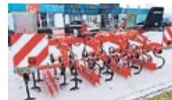
**Einböck Maishackgerät 75 cm**, 4 Reihen, Häufelschar, Lenksteuerung mech. mit Sitz
