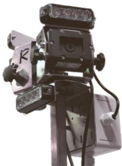
Motorwagen mit Zusatzgeräten, welche mehr als vier Meter ab Mitte Lenkvorrichtung reichen, müssen mit einem geprüften **VKMS** ausgerüstet sein. Zudem muss auf dem Anbaugerät ein gegen drei Seiten gut sichtbares, gelbes Gefahrenlicht angebracht sein. Dies soll nur in kritischen Situationen zugeschaltet werden und auf die Besonderheit des Fahrzeugs aufmerksam machen (VTS Art.109 Abs. 6).
