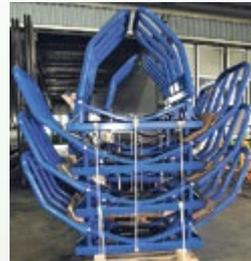
**MX Enzian 160 Rundballenzange/Ballengreifer**, Jg. 2021, 195 kg, hydr. Folienballenzange 1 Zyl., Rundballen von 80–180 cm, max. Greiferöffnung 2.1 m, Euro 8 Aufnahme, einstellbare Abstellstützen, Option Sperrblock (Mehrpreis: Fr. 190.-)
