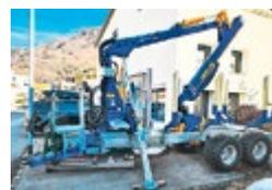
**Binderberger RW 12** neu, Jg. 2020, GG 12 t, EU DL-Bremse 30 km/h, Chassis mech. 1.2 m ausziehbar, Schwenkeichsel Untenanhangung, Binderberger Kran BK 8000, Kreuzhebelsteuerung mech., Zapfwellenpumpe
