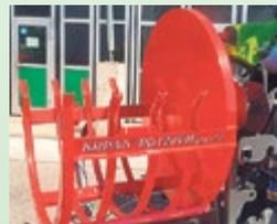
**Krpan PD 1200 H Pro Bündelgerät**, Jg. 2021, 255 kg, 3-Punt- und Euroaufnahme, hydr. auskippbar, Vorspanneinrichtung
