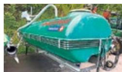
**Schallberger Typ 3500 Demo-Aufbau-Pumpfass,** Jg. 2020, Schneckenpumpe Hochdorfer, 10 bar, passend auf Aebi TP lang, Schnellkuppler für Saugschlauch, Bullauge hi., 3. Schieber mech.
