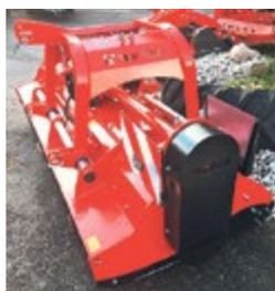
**Tehnos MU280R Profi LW** neu, Jg. 2021, Arb.br. 2.8 m, autom. Keilriemenspannung, Doppelbock für Anbau Front + Heck, hydr. Seitenschub 58 cm, Walterscheid GW
