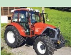
Lindner Geotrac 64 ep Jg. 2019, 76 PS, FZW FH, DL-Bremse, Steyr-Getriebe mit 2-fach-Lastschaltung, elektro-hydr. ZW, Selbstsperrdifferential vo.
