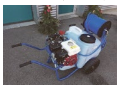
Baumspritze / Karretzenspritze 130l mit 50m Schlauch und Spritzpistole Jg. 2021
