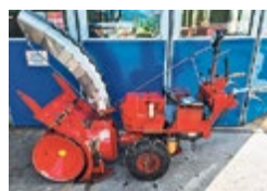
Rapid 405 mit Zaugg Schneefräse, Hydrostat, 16 PS, Räum- breite/-höhe 84/50 cm, Wurf- rad-Ø 45 cm, Breitreifen, Schneeketten, Arbeits- scheinwerfer, guter Zustand Preis: Fr. 3'850.- Telefon 033 748 87 00 www.riebenag.ch
