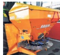
Rauch Axeo 06.1 BMP 100-Q-HC, Jg. 2015, Vol. 560 l, NL 1 t, 3-Punkt Kat. 1, hydr. Scheibenantr. 45–65 l/min, Rührwerk AX220 f.CH-Salz, Arb.br. 1–4.5 m, Behälter- boden/Streuscheibe/ Schieber/Streubreitenver- stellung aus Edelstahl Preis: Fr. 8'120.- Telefon 079 313 33 30 www.petermaschinen.ch
