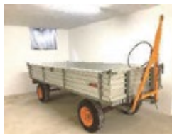
Tanner L-5, GG 6.6 t Hydr. 1-Leiterbremse, Bremsen + Reifen 10/75-15, Neu, Alu Wände Brücken-Innenmasse L=4.45 m, B=1.75 m, H=0.50 m Sehr guter Zustand Preis: 5800.00
