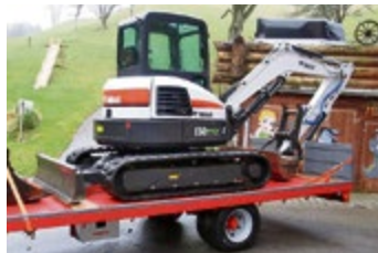
Tanner Swisstrailer Cargo PT 260 , Jg. 1994, 620 kg, GG 2.6 t, Innenmass 3750 x 1840 mm, Seiten- ladenhöhe 300 mm, Innen- höhe Blachen-Verdeck 1650 mm, höhenverstell- bare Deichsel, ab MFK Preis: Fr. 5'400.- Telefon 033 748 87 00 www.riebenag.ch
