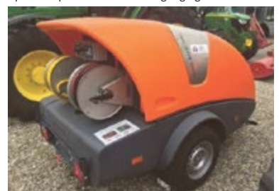
SONDI Weedkiller, Unkrautbekämpfung mit Heisswassermethode, kann gemietet werden. Jg. 2020
