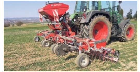
Im Vordergrund der unbearbeitete verkrustete Boden mit den nur eingeschränkt wachsenden Pflanzen, hinter dem Güttler GreenMaster mit Ripperboard und Striegel, aber ohne Walze, der aufgebrochene Boden für zügiges Wachstum der Pflanzen.
