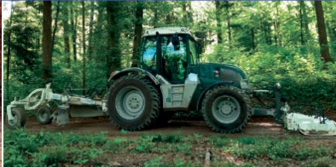
Stehr, das ultimative Wegpflegesystem. Aufreissen – Mischen – Profilieren – Verdichten
