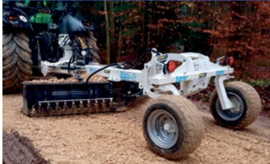
Stehr, das ultimative Wegpflegesystem. Aufreissen – Mischen – Profilieren – Verdichten
