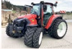
Lindner Lintrac 100 117 PS, Vierradlenkung, gefederte Vorderachse
