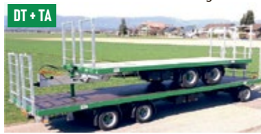
DT 240 - 24 To. (Nutzlast: ca. 19.0 To.) 1010 x 255 cm - Super Single oder Zwilling TA 160/190/210 - 16/19/21 To. 650/700/750/800 x 250/255 cm
