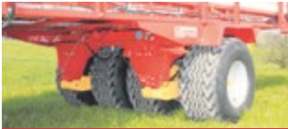
4-Rad-Fahrwerke starr und gefedert, 10t bei 40 km/h
