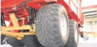
6-Rad-Fahrwerke Lift- od. Lenkachse, 14t bei 40 km/h
