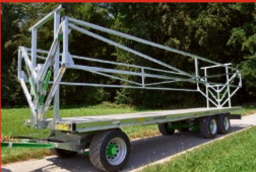
Joskin WAGO 24 t, Seitenschiene hydraulisch 24 t, ridelles hydrauliques
