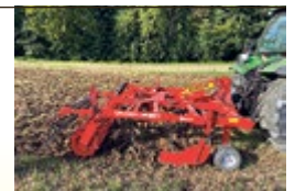
Ökogrubber GSÖ-3 , Arbeitsbreite 3m, mit Nachläufer RPV480
