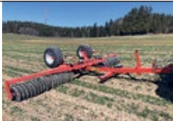
3-teilig hydr. klappbar, div. Arbeitsbreiten, Beleuchtungsanlage
