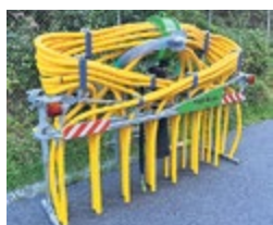
Hochdorfer Modesto N/M, Jauche-Schlepp- schlauchverteiler, neu, Arb.br. 7.2m, Transp.br. 2.5m, Anfahrssicherung, Seiten- arme mech. 180° einklappbar Preis: Fr. 11'300.–
