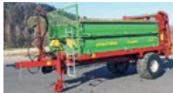
Strautmann CS 75 Vol. 7.5 m³, 5.7 t Ges.gew., Streuwerk 4-Walzen mit Brems 2-Leiter hydr. oder DL, Bereifung 520/50-17 Vredestein Flotation Trac Preis: Fr. 31'000.-
