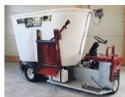
Jay-Lor A5100 Vertikalmischer, Volumen 2.6 m³, selbstfahrend, mit Schneidmessern, Allrad- antrieb, Waage, Benzin- motor 23 PS Preis: Fr. 31'500.– exkl. MwSt.
