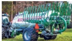
Agrar DF 6500 3 Sicherheitssyst. + Saug- flansche li.+re., 1 Saug- schlauch + 1 -rohr à 3 m, 2-Leiter Bremsanl. mit ALB- Regler über Füllstands- anzeige; Agrar SVK-750/30 , vollverzinktes Schlepp- schlauchgestänge, Arb.br. 7.5 m, hydr. ein-/aufklappbar Preis: auf Anfrage Telefon 062 897 14 66 www.odermatt-lm.ch
