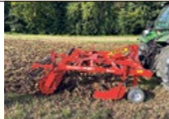
Ökogrubber GSÖ-3, Arbeitsbreite 3 m, mit Nachläufer RPV480
