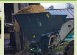
MEHRTENS EINSTREUGERÄT neu, Jg. 2022, 370 kg, Selbstbefüllung des Schüt- telgutes oder der Ballen, für Sägespähne (Sägemehl) oder gehäckseltes Stroh und natürlich Strohballen, Rührwerk mit Messern, Auswurf li. + re., Wurfweite 4 m, erforderliche Ölmenge 30 l/min Preis: auf Anfrage
