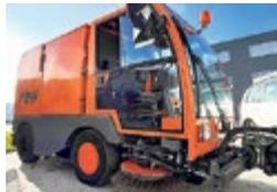
**Hochdorf MFH 2200 Kehrsaugmaschine**, Jg. 2000, 3075 Std., 80 PS, 40 km/h, hydrostat. Antrieb, zul. GG 5.7 t, NL 2.7 t, Arb. geschw. 0-15 km/h, Behältervolum. 1.7 m³, 500 l Wassertank, Wasserpumpe 20 bar max. 150 l/min, ab Kontrolle
