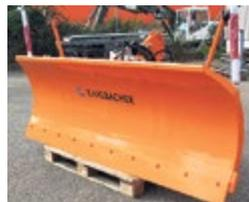
**Kahlbacher SL 2-200 neu**, Jg. 2022, 3-Punktaufbau, Gleitschuhe, Schürfleiste Stahl, Pflugbreite 224 cm, Räumbreite bei 30° Schrägstellung 200 cm, 1 Pflugschar, ca. 400 kg
