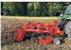
**Ökogrubber GSÖ-3**, Arbeitsbreite 3 m, mit Nachläufer RPV480
