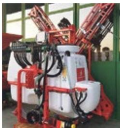
**Agromechanika AGS 800 EN**, neu, Jg. 2022, 850 kg, Inh. 800 l, Frischwasser 80 l, Gestänge HLX 15 m, 7 Sektoren, 3-fach Düsenträger, Saug- und Druckfilter, Pumpe 150 l/min bei max. 20 bar, 1 Satz Antidriftdüsen; a.V. kont. Innenreinigung hydr. (+Fr. 4'300.–)
