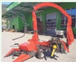
**Vicon MH90S Twin Maishäcksler**, Jg. 2002, 550 kg, 2-reihig mit einem Häckselrad, 10 Messer
