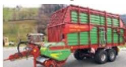
**Strautmann Ambion 290**, Vol. nach DIN 28 m³, 47.6 m³ mittlere Pressung, Schwingenwagen mit 6 Messern, Tandemachse Bereifung 520/50-17, Ladeautomatik, Bremse DL mit ALB, MFK 40 km/h, Pick-up **FLEX-LOAD**
