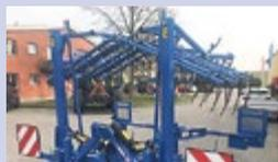
**Carre Sarclerse 6 m Unkrautstriegel, neu**, Jg. 2022, 650 kg, Arbeitsbr. 6 m, Transportbr. 3 m hydr. klappbar, 4 Elemente à 1.5 m, 120 Doppelzinken 7 mm, geeignet für Traktoren ab 50 PS
