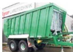
**Reisch RTAS-180.575 Eco remorque à fond poussant tandem**, année 2022, poids total 21 t, taille de la cavité 5.575×2.37×2.1 m, vol. env. 29.5 m<sup>3</sup>, axe de direction de suivi BPW 410×120, attelage K80, frein à air sur les 4 roues (double conduite), 40 km/h, sans MFK
