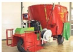
**Strautmann Verti-Mix ESF-H**, Austrag beidseitig oder hinten mittig, Antriebe über E-Motor – DIE Lösung für maximale Flexibilität – Standardlösungen angepasst auf Ihren Betrieb!
