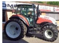
**Steyr Kompakt 4100 Demo**, Jg. 2022, 100 Std., 100 PS, 3 DW, FH, FZW, 2 mech. Steuergeräte mittig m. Kreuzhebelbedienung inkl. Taster für 3. Funktion, Frontpaket Alpin, hydr. Entlastung; DR + DR-Beleuchtung optional
