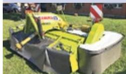
**Claas Disco 3200 FC Profil Frontscheibenmäherwerk**, Jg. 2023, Arb.br. 3 m, Max-Cut-Mähbalken, Messer-Schnellwechselsystem
