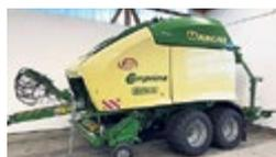
**Krone Comprima CV 150XC X-treme**, Jg. 2014, 9310 Ballen, Ø 1-1.5x1.2m, 1 EW + 1 DW nötig, Bordhydraulik, hydr. absenk-bare Messerkassette, hydr. Messergruppenschaltung, 17 Messer, autom. Kettenschmierung, Netz- und Folienbindung, 2-Leiter-DL-Anlage, ab MFK 40 km/h
