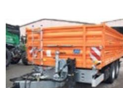
**Reisch RUTDK-140 benne basculante 3 côtés**, neuve, année 2022, poids total 14 t, taille de la cavité 4.6×2.42 m, taille du punt 500 mm, syst. de freinage à air 2 conduites avec ALB, embrayage duomatic, 40 km/h, sans MFK
