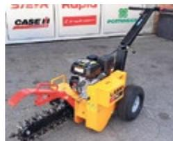
**Laski TR-50/7 Grabenfräse, neu**, Jg. 2022, 7 PS Kohler Benzinmotor, Grabentiefe bis 50 cm, Grabenbreite 10 cm, ab Lager
