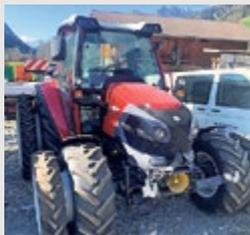
**Lindner Lintrac 75 LS Ausstell-Traktor**, Jg. 2022, 76 PS, 75 Std., 3 DW, FZW, FH, DL-Bremse, LS Hydr.pumpe 55 l/min
