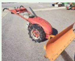
**Bucher Schneepflug 1.60 m, Einachser, MAG Benzin Motor 9 PS, Schneeketten, mit Stahl-Schürfkante + 2 Gleitkufen**
