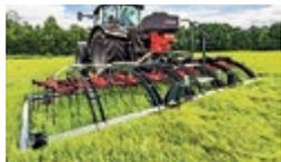
**Saphir Grünlandstriegel GS 603 mit pneum. Sägerät DrillStar 300E, Demo**, Jg. 2021, zur mech. Unkrautbekämpfung und Belüftung der Grasnarbe, 12 bodenschonende Gleitkufen
