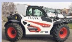
**Bobcat TL30.60 Demo-Teleskoplader**, 100 Std., 5350 kg, 100 PS, 3t Hubkraft, 5.80 m Hubhöhe, hochleistungs-Hydrostatik-antrieb mit 2 Fahrstufen, Eco-Modus, 100 l/min Hydraulikleistung, Geschwindigkeit stufenlos 0-40 km/h
