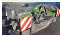
**Fendt Cutter 3140 FPV Demo-Fronttrommelmäherwerk**, Jg. 2021, 875 kg, Arbeitsbr. 3.06 m, Transportbr. 3 m, Anbau mit Pendelbock +/- 5°, klappbare Aussenschütze, 4 Mäh-trommeln mit je 3 Klingen
