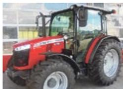
**Massey Ferguson 4710M Dyna 2**, 100 PS, 6 Ganggetriebe mit Lastschaltstufe, Klima, Druckluft und hydr. Bremse
