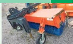
**Tuchel Maxi 800 Demo-Kehrbürste**, Arbeitsbreite 2.40 m, Bürstenbesatz 80 cm, hydr. Schwenkung links und rechts, 3-Punktanbau Front+ Heck
