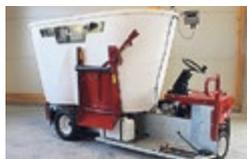
**Jaylor A5100 Vertikalmischer**, Volumen 2.6 m<sup>3</sup>, selbstfahrend, mit Schneidmessern, Allradantrieb, Waage, Benzinmotor 23 PS
