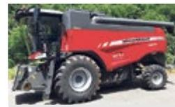
**Massey Ferguson Beta 7360 PLi**, neuve, année 2022, hydrostat. avec 4 vitesses, 306 cv, traction intégrale, caméra de recul + 2e caméra sur crochet d'attelage, 5 secoueurs avec MCS Plus, broyeur de paille, barre de coupe PowerFlow 5.5 m, multi coupleur, 2 cisailles à colza électr., chariot de barre avec frein à main et caisse pour l'équipement colza
