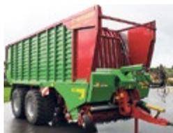
**Strautmann Magnon 430 CFS DO, Demo 2022**, Vol. nach DIN 40 m³, 74 m³ mittlere Pressung, Rotorladewagen mit 4 Messern, Tandemachse, Nachlaufenkung, Bereifung 800/45-R30.5, Ladeautomatik, Bremse DL mit ALB, MFK 40 km/h, Pick-up **FLEX-LOAD**
