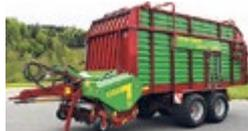
**Strautmann Zelon 2901 CFS**, Vol. nach DIN 23 m³, 39.1 m³ mittlere Pressung, Rotorladewagen mit 3 Messern, Tandemachse, Nachlaufenkung, Bereifung 620/40-22.5, Ladeautomatik, Bremse DL mit ALB, MFK 40 km/h, Pick-up **FLEX-LOAD**
