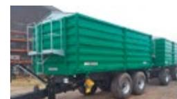
**Wagner Kipperzug** Vorführmodell, Jg. 2021, Tandemkipper 21 t und 2-Achskipper 18 t, mit Rollplane, Bereifung 445/65 R22.5, Bordwände 1.6 m, ab MFK 40 km/h
