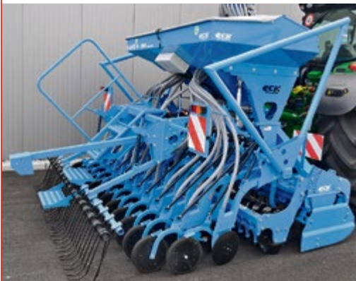
ECK C-Drill 9-300 Sämaschine pneumatisch, mit Kreisel- egge 220 KW, Deutsches Produkt Combinaison de semi pneumatique, avec herse 220 KW
