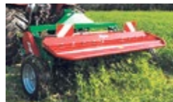
Agrar Intensivauflbereiter IC 16–IC 18–IC 20, Jg. 2023. Trennung von «Mähen vor- ne» und «Aufbereiten hin- ten» ermöglicht leichteres Trägerfahrzeug. Lockere und breitere Futterablage verkürzt Trocknungsdauer Preise: auf Anfrage Telefon 052 631 16 00 www.agrar-landtechnik.ch
