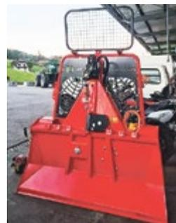
**Oehler OL SW 8500P EH SA, Seilwinde mit Funk, neu,** Jg. 2023, Zugkraft 8.5t, 90 m 13 mm Seil, hydr. Seilausstoss m. Seileinlaufbremse, untere Seilrolle, inkl. GW
