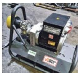
**Agrowatt 30 kVA ZW-Generator/Notstromaggregat, neu,** Jg. 2022, 228 kg, el. Regulierung RPM 1500, Dauerleistung 30 / 10 kVA bei 400 / 230 V, Traktor-Leistung 75 PS
