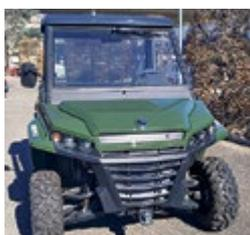
**Snopex Corvus DX4 Ausstellmod.,** Jg. 2021, 10 Std., 24 PS, 764 kg, Variomat Getr., Anh.last 907/450 kg gebremst/ungebremst, Zuladung 450 kg, 40l Tank, Einzelradaufhängung
