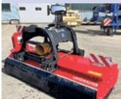
**Votex Landmaster 240, Front-Heckmulcher**, Jg. 2022, 860 kg, Arb.br. 2.4 m, hydr. Seitenverschiebung, Hammerschlegel
