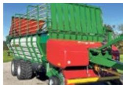
**Agrar TL 45 L5 Demomodell**, Jg. 2023, DL-Anlage, Ladeaggregat m. 5 versetzten Förder-schwingen, 1.9 m Pick-up m. Rollenniederhalter + seitl. Zuführflappen, 5 Einzelmesser, hydr. Knickdeichsel EHF, Kratzboden EHF, 2-Leiter-DL-Bremse mit ALB Lastenregler 40 km/h, WW-GW m. Nockenschaltkupplung, ab MFK
