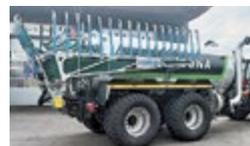
**Bonsegna 11500 Ltr. Tandem-Güllefass**, Vakuum-Pumpe 13500 l/min, Saugarm rechts, Turbofüller, Bereifung 710/50 R26.5 BKT A 10 FORI, Bomech Schleppschuhverteiler Speedy One 10.50 m
