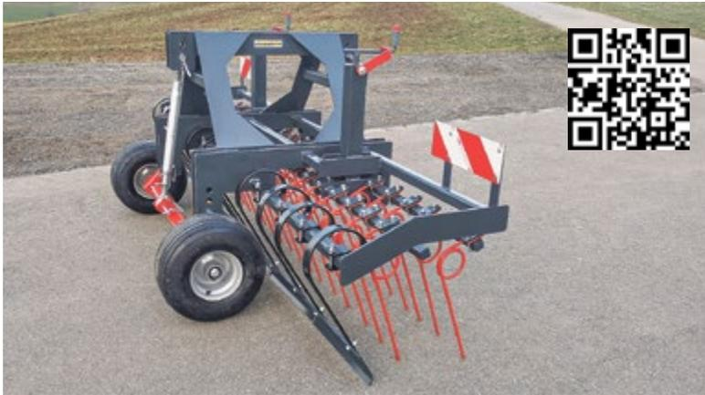
Der kompakte Wiesenstriegel eignet sich für Front- oder Heckanbau. Es besteht auch die Möglichkeit im Heck mit einer Walze zu kombinieren.
