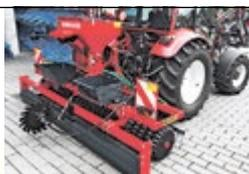
**Cambridge oder Sternring-Walzen** mit Sägerätaufbau und Beleuchtungsanlage
