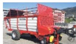
**SIP Senator 22/9 Demo-Tiefganglade-wagen**, Jg. 2023, 22 m³, hydr. Pick-up, hydr. Kratzboden, hydr. Rückwand, hydr. Knickdeichsel, 3 Messer, hydr. 1+2-Leiter-Anhängerbremse
