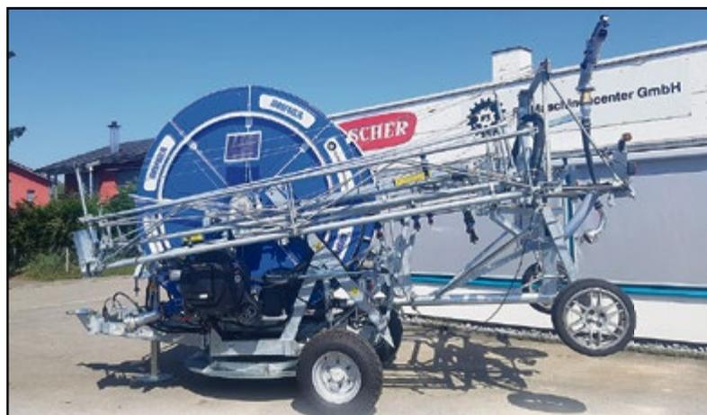
**Beregnungsmaschinen von FS-Maschinencenter seit Jahrzehnten bewährt.** Robuste, betriebssichere und überlegene Technik. Einfache Installation ohne Kulturschäden. Einzigartig, effizient und leistungsfähig. Mit klappbarem Beregnungsbalken und hydr. Maschinen-Absenkung. Schlauchlänge und Schlauchdurchmesser nach Kundenwunsch.
