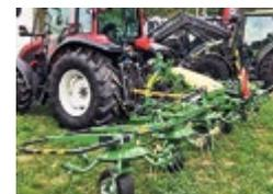
**Krone Vendro 680 Kreiselheuer, neu**, 950 kg, 6 Kreisel, OptiTurn 3D-Zinken, Schwenkbock mit autom. Zentrierung + mech. Dämpfer; opt.: hydr. Randstreu- vorr., Tastrad usw.
