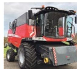
**Massey Ferguson Centora 7380 AL**, année 2016, 1025h, hydrostat. 4 vitesses, machine 8 se-coueurs, broyeur de paille, épandeur de paille, barre PowerFlow 6.2m, chariot avec frein à main
