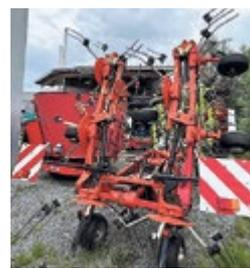
**Fella TH 900D Hydro Kreiselheuer**, 1080 kg, Arb.br. 8.6 m, Leistungsbedarf ca. 75 PS, 3-Punkt-Anbau Kat. 1 + 2, erf. Hydr. anschlüsse 2x EW + 1x DW, hydr. Vorgewendeaushebung + hydr. Grenzstreu- vorrichtung, 8 Kreisel à 6 Zinkenarme
