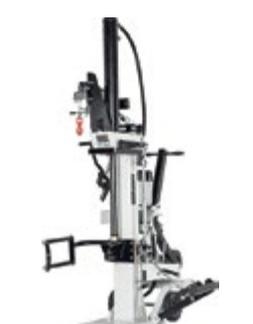
**Lumag HEZ-22 Profi-Brennholzspalter, Spaltkraft max. 22 t, Spalthub 94.8 cm, Spaltlänge 56–110 cm, 3-Punkt-Aufhängung Kat. I + II, Schlepperleistung 20 PS, 110 × 150 × 250 cm**
