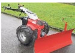
**Aebi CC 56 Motormäher, Jg. 2011, 13 PS, hydrostat. Antrieb, Schneeflug Erismann 1.3 m mit Seitenblechen + höhenverstellbaren Laufrollen, ab Service**
