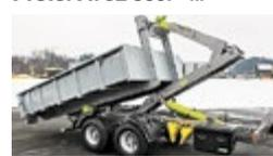
**Hakengerät MEC R.737** GG 13t, Muldenlänge bis 4200 mm, Bremse DL mit ALB, ohne Mulde
