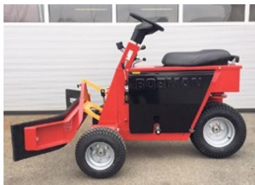
optimal auf den Boden bringen und auch schwere Lasten schieben. Für die Aufnahme von Arbeitsgeräten befindet sich an der Front ein Accord-Dreieck. Der Antrieb der Geräte erfolgt über ein doppelwirkendes Steuergerät, damit können diverse Anbaugeräte angetrieben werden. Die Anbaugeräte wie Futterschnecke, Mistschieber, Kehrbesen etc. machen den Pro zum flinken und wendigen Helfer auf dem Hof. Folgende Geräte befinden sich in der Schweiz seit Jahren im Einsatz:
