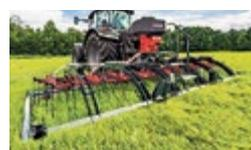
**Saphir Grünlandstriegel GS 603 mit pneum. Sägerät DrillStar 300E, Demo, Jg. 2021**, zur mech. Unkrautbekämpfung und Belüftung der Grasnarbe, 12 bodenschonende Gleitkufen
