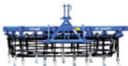
Rabe Bluebird GR neu, Jg. 2022, verstärkter Anbauturm Kat. III N, 3 Zinkenreihen, Arbeits- tiefe bis 30 cm, Rohrstab- walze Ø 540 mm Preis: Fr. 12'900.- Kontakt: Reto Maugweiler Telefon 076 463 51 15 www.agrar-landtechnik.ch
